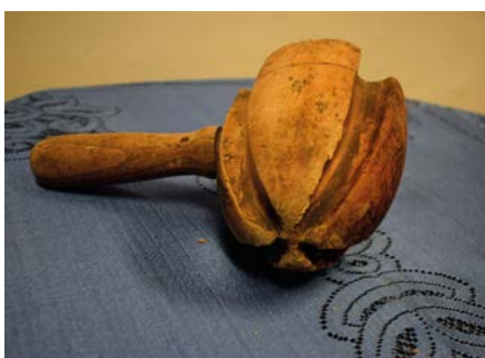
Zabytkowe narzędzie wykorzystywane przez powroźników do równomiernego skręcania sznurków.
